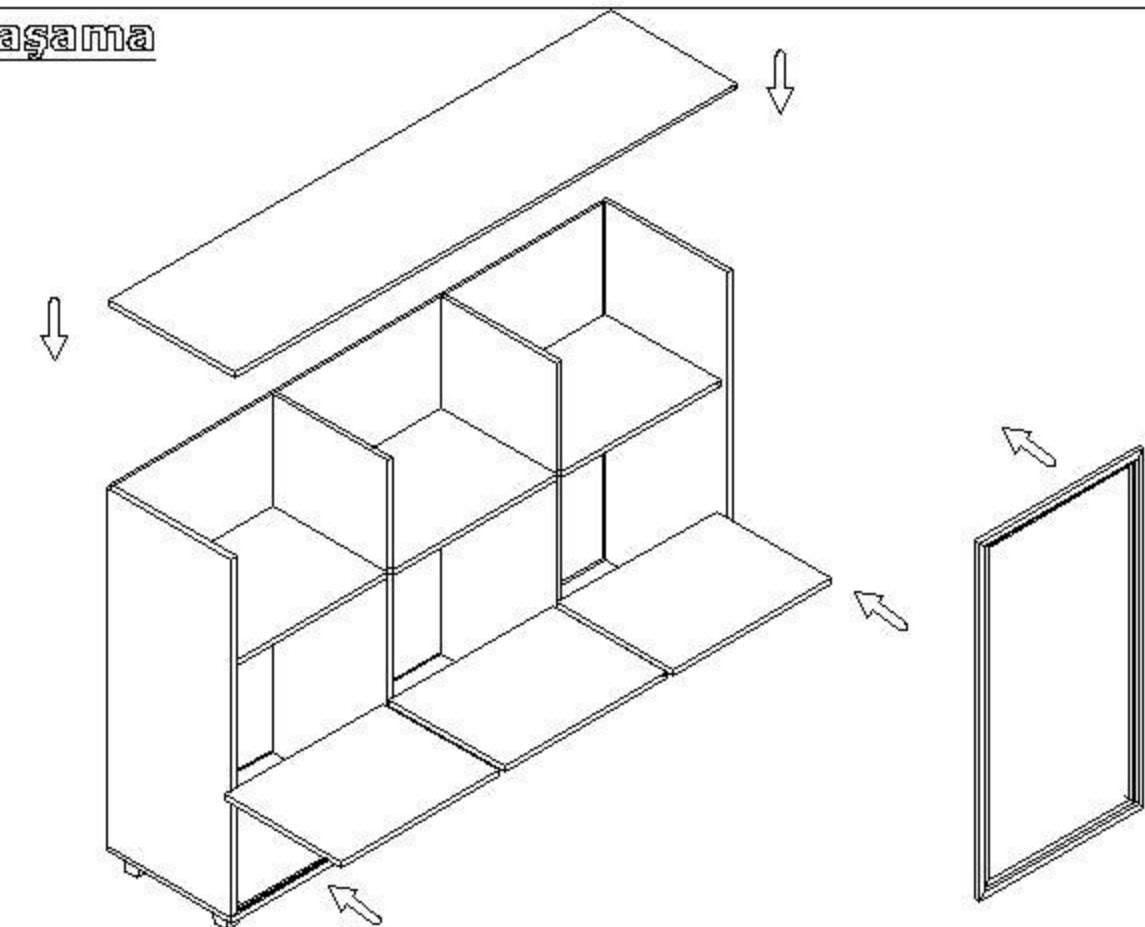
Son aşamada;dolap taci minifix yardımıyla bağlanarak,Sürgülü cam kapaklar raylarına takılır.Dolap içlerine raf plmeleri takılarak hareketli raflar yerleştirilir.
