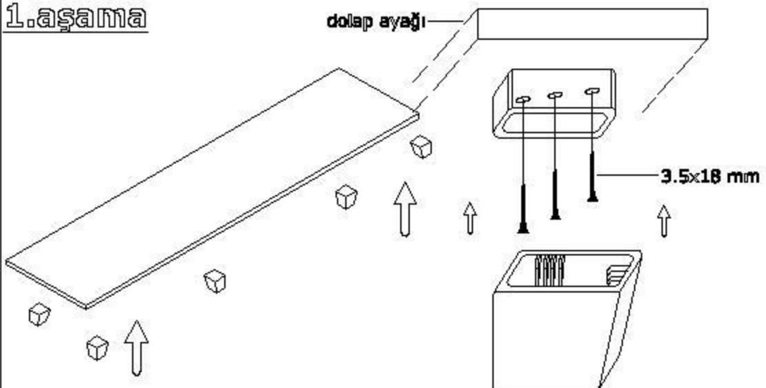
İlk olarak; 8 adet vazo ayakları 3.5x18 mm'lik toplam 24 adet vida yardımıyla dolap altına bağlanarak kapak üzerine takılır.
