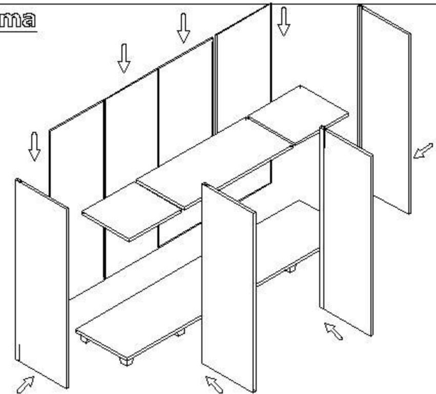
2. aşamada dolap yanları minifix yardımıyla alt tablaya bağlanarak yanlarda bulunan kanallardan arkalarından geçirilerek sabit raflar minifix yardımıyla yan gövdeye bağlanır.
